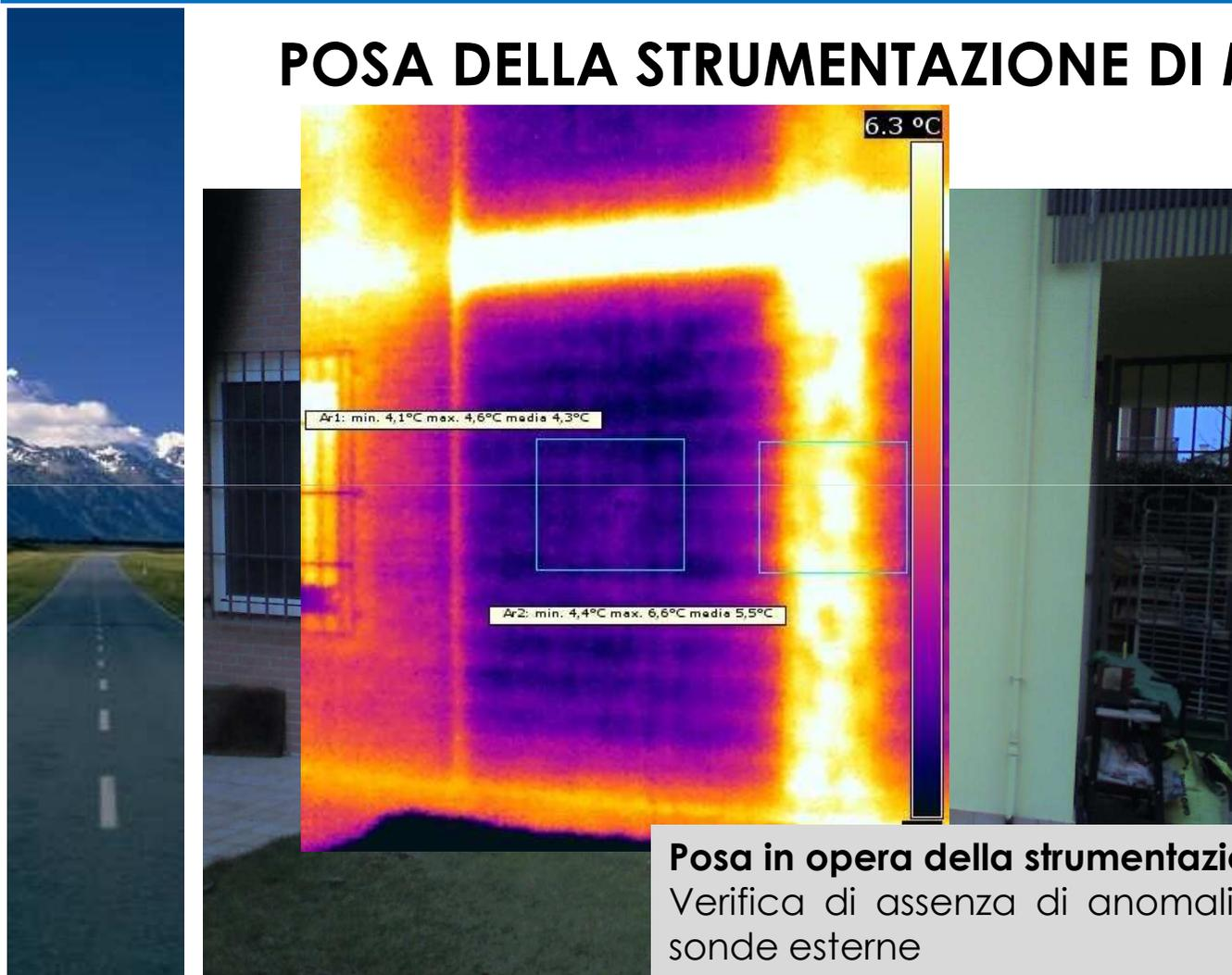
Indagine termografica per l'individuazione della corretta posizione di installazione delle sonde
