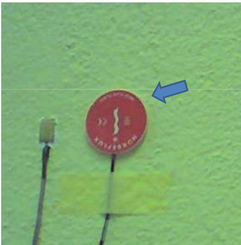
Il **termoflussimetro** è un dispositivo contenente un trasduttore che genera un segnale elettrico in funzione del **flusso di calore** che lo attraversa.
